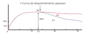
La curva de desprendimiento gaseoso determina el coeficiente de retención R (la relación entre el % del volumen retenido en la pasta y el volumen total de gas producido durante la prueba).
